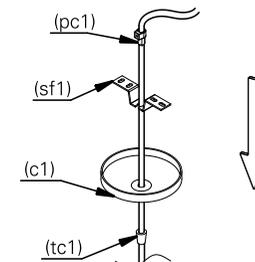
2. utilize o parafuso (p1) para fixar o suporte de fixação (sf1) na caixa de alimentação ou no forro.
