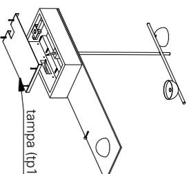
2. com o auxílio de um lápis marque a posição dos furos na parede e fure os locais demarcados utilizando uma furadeira. encaixe as buchas (b1) de fixação e passe os fios de alimentação pelo corpo da luminária (co1) e fixe-a com os parafusos (pr1).
