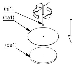
2. fixe a haste superior (hs1) rosqueando na haste inferior (hi1). pule este passo nos modelos que não possuem haste superior: (micro bauhaus 90 t / mega bauhaus 90 t)
