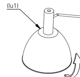
7. a luminária após instalada deverá ficar como ilustrado na imagem. ligue a rede elétrica e teste o seu funcionamento.
