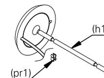
6. encaixe o cabo de alimentação na presilha (pr1).
