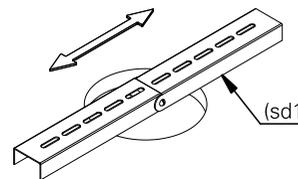
**3.** passe o suporte de fixação (sf2) pelo suporte dobrável (sd1) em seguida posicione-o.
