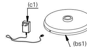
coloque a luminária (lu1) sobre a base (bs1) encaixando os conectores, ascenderá a luz de carregamento. seu posicionamento deverá ficar como ilustrado na imagem abaixo.
