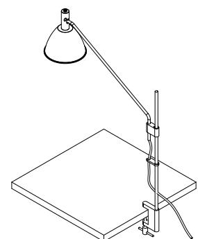
8. alimente a luminária ligando a tomada na rede elétrica e teste seu funcionamento.
