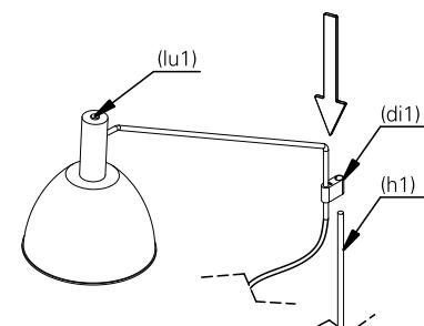
4. para regular a altura da luminária, incline levemente a haste da luminária (lu1) e move-a para cima ou para baixo.
