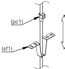
3. utilize o parafuso (p1) para fixar o suporte de fixação (sf1) junto com o chassi (ch1) na caixa de alimentação ou no forro.
