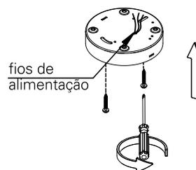
4. faça a ligação com a rede elétrica utilizando conectores.
