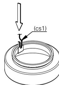
3. passe os fios de alimentação pelo orifício da luminária. utilize o parafuso (p1) para fixar o chassi (ch1) na caixa de passagem.
