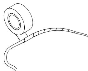
**4.** para regular a altura da luminária, folge os parafusos (p2) e enrole o cabo (cb1) nos distanciadores (dt1).
