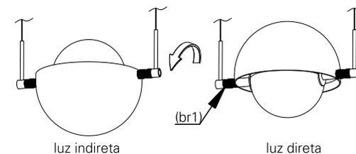
**7.** a luminária após instalada deverá ficar como ilustrado na imagem. ligue a rede elétrica e teste o seu funcionamento.
