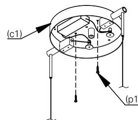
**3.** faça a ligação elétrica. isole os fios separadamente com fita isolante. repita a operação envolvendo o conjunto dos fios, vedando completamente a emenda.
