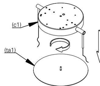
**2.** utilize o parafusos (p1) para fixar a canopla (c1) no local.
