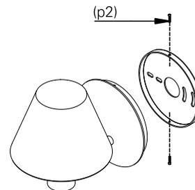
2. passe os fios de alimentação pelo orifício da canopla (c1). utilize os parafusos (p2) para fixar a canopla (c1) na caixa de passagem.
