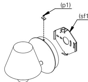
**2.** passe os fios de alimentação pelo orifício do suporte de fixação (sf1). utilize os parafusos (p2) para fixá-lo na caixa ou ponto de passagem.
