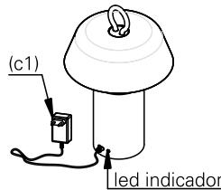
**3.** após a carga completa da luminária, desconecte o carregador.
