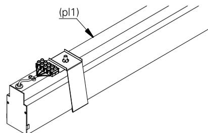
5. a luminária após instalada deverá ficar como ilustrado na imagem. ligue a rede elétrica e teste o seu funcionamento.
