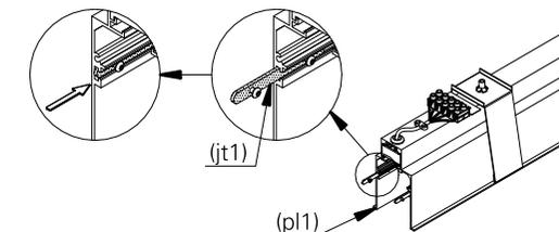
7. encaixe o segundo perfil (pl2) no forro conforme a etapa 5. centralize a junção do trilho (jt1) entre os dois perfis e aperte os parafusos conforme o detalhe interno mostrado abaixo.
