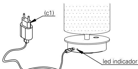
3. após a carga completa da luminária, desconecte o carregador (c1).
