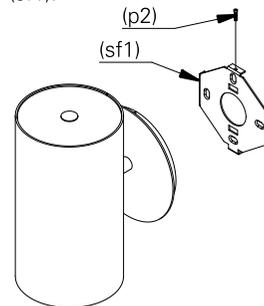
**2.** passe os fios de alimentação pelo orifício do suporte de fixação (sf1). utilize os parafusos (p1) para fixar o suporte de fixação (sf1) na caixa de passagem.
