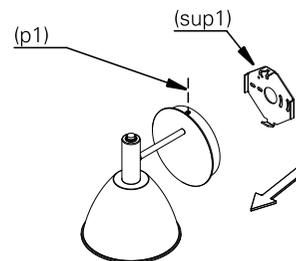
2. passe os fios de alimentação pelo orifício do suporte (sup1). utilize os parafusos (p2) para fixá-lo na caixa ou ponto de passagem.
