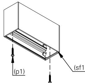
2. escolha o lado onde o fio de alimentação irá passar e faça a ligação elétrica. isole os fios separadamente com fita isolante. repita a operação envolvendo o conjunto dos fios, vedando completamente a emenda.
