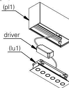
4. a luminária após instalada deverá ficar como ilustrado na imagem. ligue na rede elétrica e teste o seu funcionamento.
