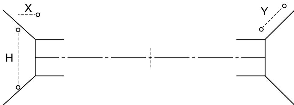
A relação recomendada entre a altura da parede e a distância da luminária à parede  $\frac{H}{X}$  está no intervalo entre  $\frac{1}{3}$  e  $\frac{1}{5}$ , mantendo uma boa homogeneidade.
