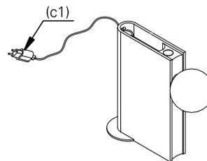
2. após a carga completa da luminária, desconecte o carregador (c1).
