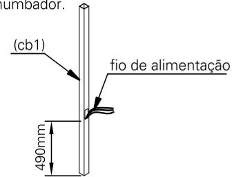
**2.** passe o cabo de alimentação pelo poste (pt1). encaixe a pétala (pe1) no poste e aperte o parafuso (p1).
