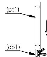
**4.** encaixe o poste (pt1) até o final e aperte os parafusos (p2).
