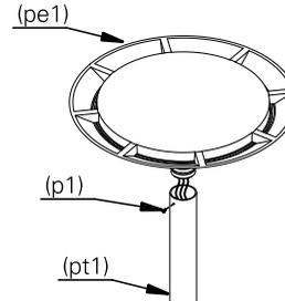
**3.** encaixe o poste (pt1) no chumbador (cb1) passando o fio de alimentação pelo recorte. faça a ligação elétrica. isole os três fios separadamente com fita de alta fusão. repita a operação envolvendo o conjunto dos três fios, vedando completamente a emenda.
