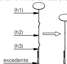
**4.** mantendo o cabo da haste (h3) passando pelo orifício conforme a imagem acima, gire todo o conjunto da luminária na base (ba1).
