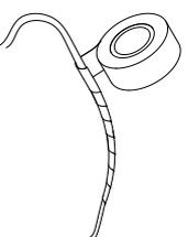
4. fure e fixe a bucha (bc1) de apoio da luminária, monte a tampa de fechamento (tp1), teste o acionamento da luminária pelo botão on/off.
