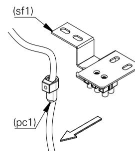
**3.** utilize o parafuso (p1) para fixar o suporte de fixação (sf1) na caixa de alimentação ou no forro.
