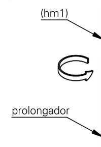
**7.** encaixe a haste maior (hm1) no suporte da haste (sh1), ajuste a altura desejada e com a chapa de aperto (cap1) de o aperto no parafuso do suporte da haste conforme demonstrado na figura.
