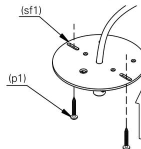
**3.** encaixe o disco de arremate (da1) e a canopla (c1) no suporte de fixação (sf1) e rosqueie o trava cabo (tc1).
