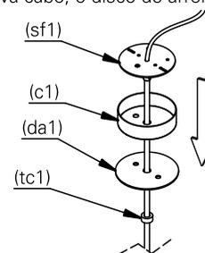
**2.** utilize os parafusos (p1) para fixar o suporte de fixação (sf1) na caixa de passagem.
