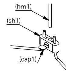
**8.** a luminária após instalada deverá ficar como ilustrado na imagem. ligue a rede elétrica e teste o seu funcionamento.
