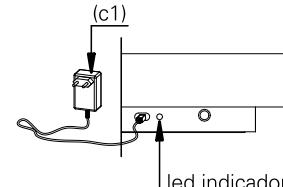
2. após a carga completa da luminária, desconecte o carregador (c1).
