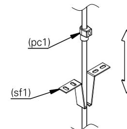
**6.** aperte a bucha (kd3) para fixar o chassi (ch1) e o suporte de fixação (sf1) no forro.
