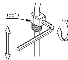
**8.** encaixe novamente o prensa cabo (pc1) no suporte de fixação (sf1). certifique-se de que o parafuso esteja bem apertado.
