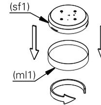
2. passe os fios de alimentação pelo orifício da luminária. utilize o parafuso (p1) para fixar o suporte de fixação (sf1) na caixa de passagem.
