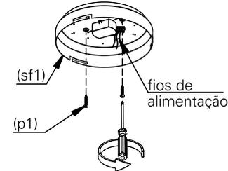
3. faça a ligação com a rede elétrica utilizando conectores, não esquecendo o fio terra.
