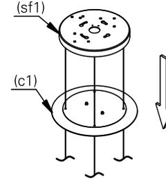
**2.** marque o local dos furos no teto usando o suporte de fixação (sf1) como referência. fure e fixe os parafusos deixando-os 5mm para fora do teto. utilize o sistema de fixação apropriado para gesso ou laje, conforme o local de instalação.
