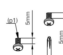
**3.** passe a fixação pelo furo do suporte de fixação (sf1). encaixe o suporte de fixação nos parafusos (p1), rotacionando para fixar. aperte firmemente os parafusos.
