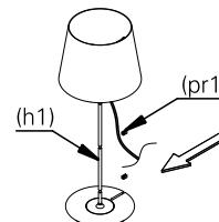
4. encaixe o cabo de alimentação nas presilhas (pr1).
