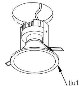
5. a luminária após instalada deverá ficar como ilustrado na imagem. ligue a rede elétrica e teste o seu funcionamento.
