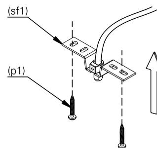
4. encaixe a canopla (c1) no suporte de fixação (sf1) e rosqueie o trava cabo (tc1).
