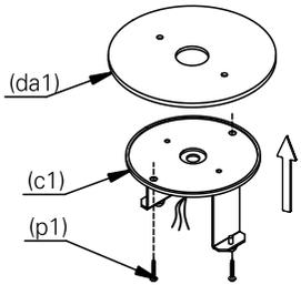
2. faça a ligação elétrica. isole os fios separadamente com fita isolante. repita a operação envolvendo o conjunto, vedando completamente a emenda.
