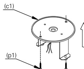
3. faça a ligação elétrica. isole os fios separadamente com fita isolante. repita a operação envolvendo o conjunto dos fios, vedando completamente a emenda.
