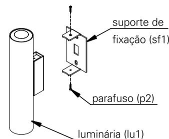
2. utilize os parafusos (p1) para fixar o suporte de fixação (sf1) na parede.
