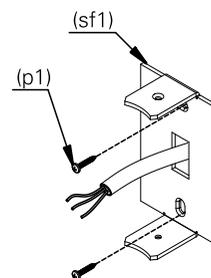
3. faça a ligação elétrica. isole os fios separadamente com fita isolante. repita a operação envolvendo o conjunto dos fios, vedando completamente a emenda.
