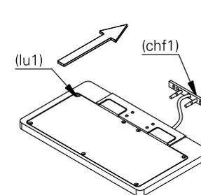
**3.2.** ajuste o nivelamento da luminária (lu1) rosqueando ou desrosqueando os parafusos (p2). após ajustado, aperte os parafusos (p3).
