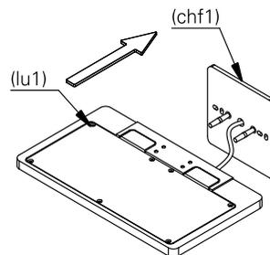
**3.1.** ajuste o nivelamento da luminária (lu1) rosqueando ou desrosqueando os parafusos (p2). após ajustado, aperte os parafusos (p3).
