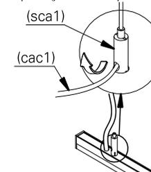
**6.** na utilização da canopla (c1), utilize os parafusos (p1) para fixar o suporte de fixação (sf1) na caixa de passagem.
