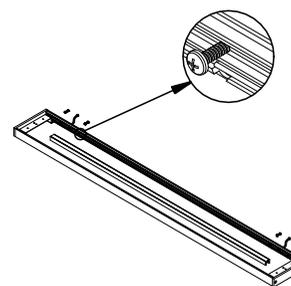
**5.** encaixe o suporte de fixação (sf1) conforme ilustrado acima e aperte o parafuso (p1). repita a operação para todos pontos de fixação.
