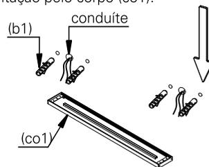
**2.** utilize os parafusos (p1) para fixar nas buchas mantendo um distanciamento de 16mm da parede conforme a imagem acima.
