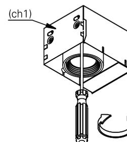
5. encaixe o cabo de segurança (cs1) no chassi (ch1). certifique-se de que o corpo (co1) está na posição correta e encaixe-o no chassi até o travamento da mola.
