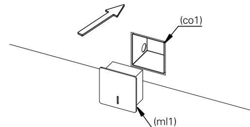
**6.** a luminária após instalada deverá ficar como ilustrado na imagem. ligue a rede elétrica e teste o seu funcionamento.
