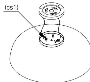
**5.** faça a ligação elétrica. isole os fios separadamente com fita isolante. repita a operação envolvendo o conjunto dos fios, vedando completamente a emenda.
