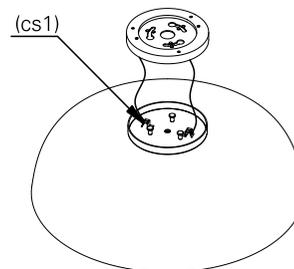
**3.** utilize os parafusos (p1) para fixar a canopla (c1) na laje.
