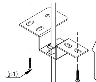
**7.** encaixe a canopla (c1) no suporte de fixação (sf1) e rosqueie a bucha (b1).
