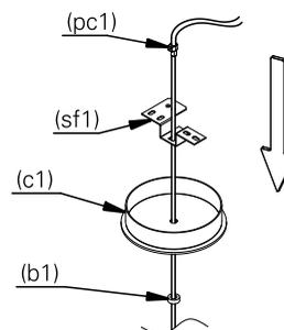
**3.** utilizando a chave allen, solte o cabo do prensa cabo (pc1) e ajuste a altura da luminária. prenda o cabo com a chave allen e corte o excedente, deixando 10cm de sobra.
