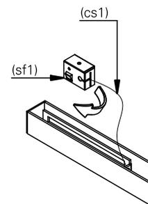
**3.** faça os furos para passagem da bucha (b1) e em seguida fixe o suporte de fixação (sf1) com os parafusos (p1).
