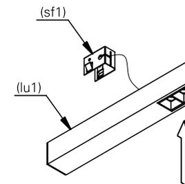
**7.** a luminária após instalada deverá ficar como ilustrado na imagem. ligue a rede elétrica e teste o seu funcionamento.
