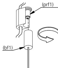
**4.** no lado oposto da luminária (lu1), utilize o parafuso (p1) para fixar o p-fit (prf1) no forro e em seguida rosqueie o b-fit (bf1).
