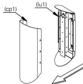
2. com o auxílio de um lápis e da luminária (lu1), marque a posição dos furos na parede, fure os locais demarcados utilizando uma furadeira e encaixe as buchas (b1) de fixação.
