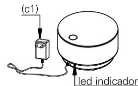
**3.** após a carga completa da luminária (lu1), desconecte o carregador (c1).
