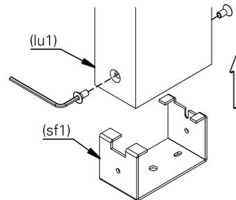
**2.** passe os fios de alimentação pelo orifício do suporte de fixação (sf1).
