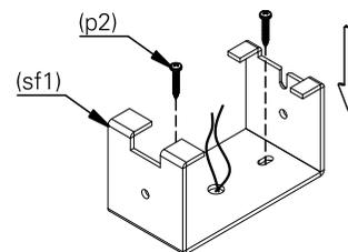
**3.** faça a ligação elétrica. isole os fios separadamente com fita isolante.
