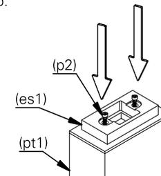
8. retire o parafuso (p1) e passe o cabo de alimentação por dentro do poste (pt1). encaixe a luminária nos parafusos allen (p2).
