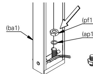
6. faça a ligação elétrica. isole os fios separadamente com fita isolante. repita a operação envolvendo o conjunto dos fios, vedando completamente a emenda.
