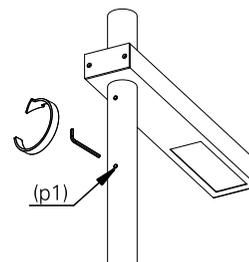
**5.** faça a ligação elétrica na base do poste (pt1). isole os fios separadamente com fita de alta fusão. repita a operação envolvendo o conjunto dos três fios, vedando completamente a emenda.
