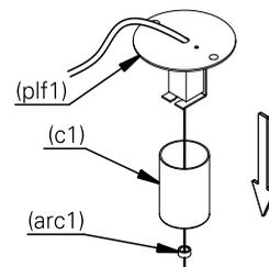
**2.** faça a ligação elétrica. isole os três fios separadamente.
