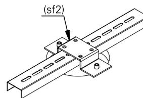
**5.** utilize o parafuso (p2) para fixar a suporte de fixação (sf2) no suporte de fixação (sf1).
