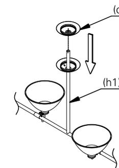
**7.** encaixe a haste (h1) no suporte de fixação (sf1).
