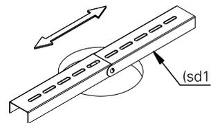
**3.** passe o suporte de fixação (sf2) pelo suporte dobrável (sd1) em seguida posicione-o.
