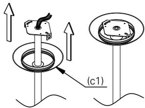
**11.** solte o parafuso de nylon (pn1) parcialmente e ajuste o ângulo da luminária e em seguida aperte o parafuso de nylon (pn1).
