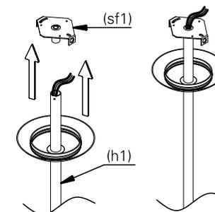
**8.** utilize o parafuso (p1) para fixar a haste (h1) no suporte de fixação (sf1).
