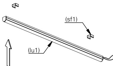
3. faça a ligação elétrica. isole os fios separadamente com fita isolante.
